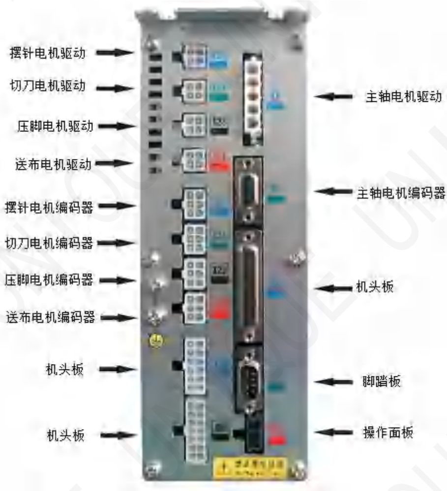
MASC500 电控箱后板接线图
